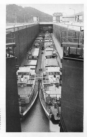
Der aus sechs Einheiten bestehende Schub-koppelverband "Mur-Möll" der Comos, eine Kombination, die mit 2100 PS Leistung 5740 Tonnen zu befördern vermag, in einer der beiden Schleusenkam-mern des Donaukraftmern des Donaukraft-werkes Aschach.
